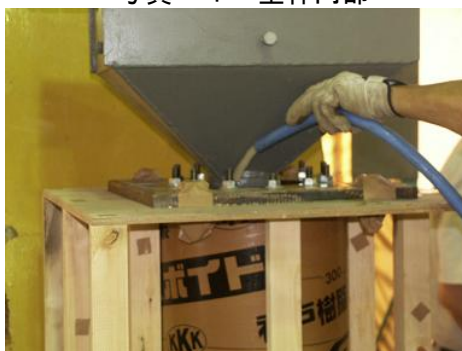
写真-2 ベントナイト液注入
