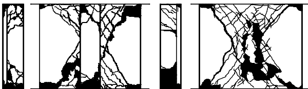
図-4 せん断力(Q)と部材角(R)の関係 及び最終破壊状況
