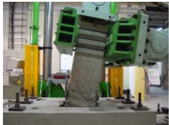
写真-3 No-3 試験体水平変位 180mm 時 (部材角 1/5) の損傷状態
