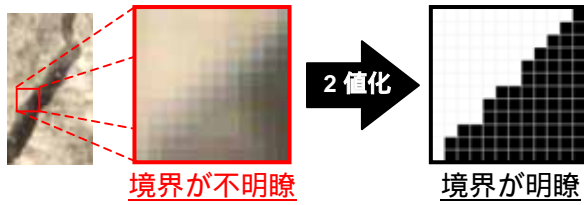
(a) 2 値化によるひび割れの境界の明確化
