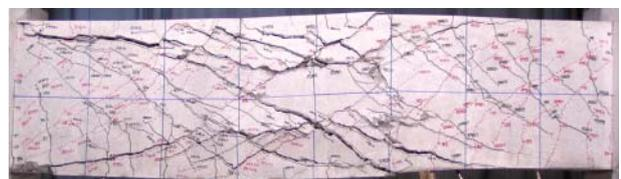
写真-1 No.2 破壊状況( $R=1/33rad.$ )
