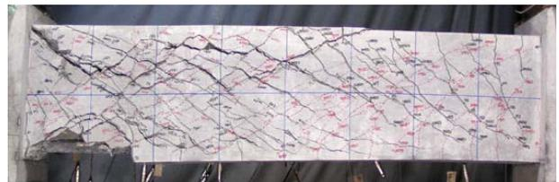
写真-6 No.9 破壊状況 (R=1/33rad.)
