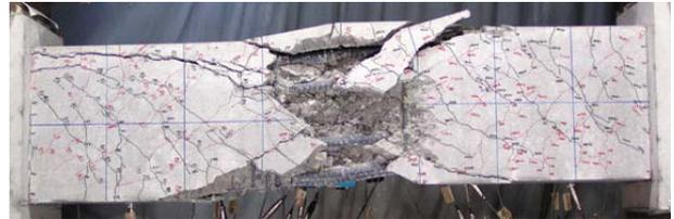
写真-4 No.7 破壊状況 (R=1/33rad.)
