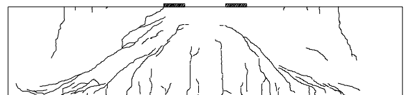
図-4 B14供試体最大耐力時クラック図
