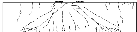
図-3 B15供試体最大耐力時クラック図
