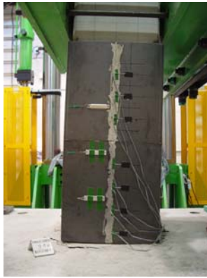
(a) 最大荷重時 (7δy 荷重時)
