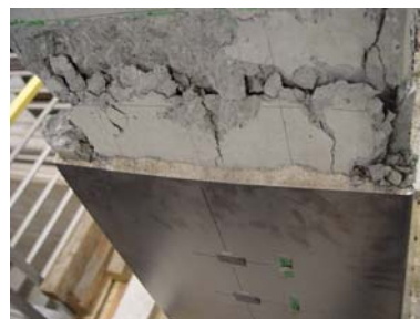
(e) 試験終了後 砂充填状況
