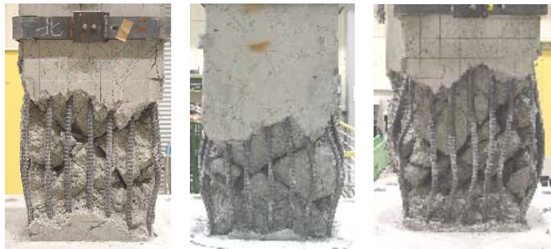
LR-1 LR-2 LR-3 写真-2 LRシリーズの損傷状況（実験終了後）
