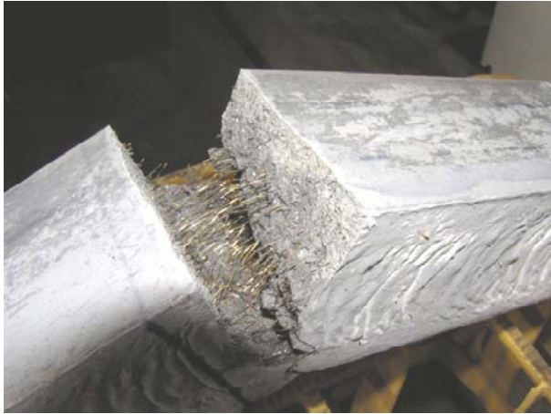
写真-3 応力比 0.5 の破壊面
