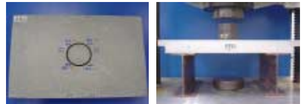
写真 - 3 押抜き供試体と実験状況
