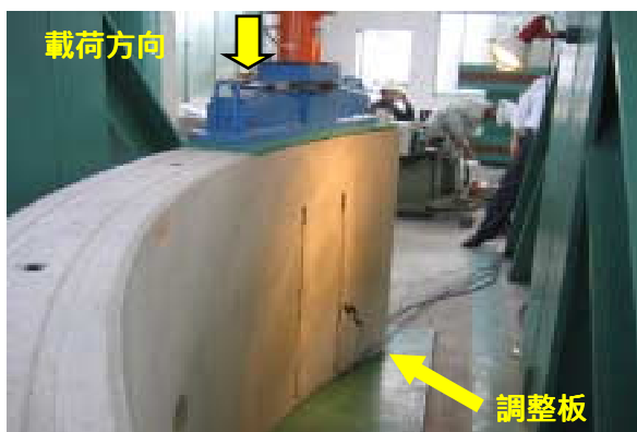
写真-7 偏圧载荷実験状況
