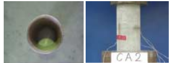
写真 - 2 シートの布設と圧縮実験状況
