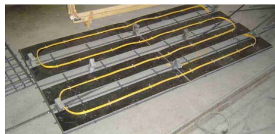
写真-2 発熱ヒーター
