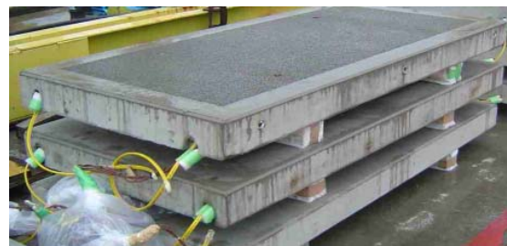
写真-1 融雪排水コンクリート舗装版
