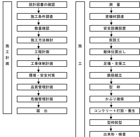
図-5.1 施工計画および施工の流れ
