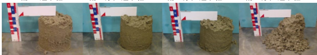
写真-4 スランプ状況(粗骨材に過小粒を含む場合)
