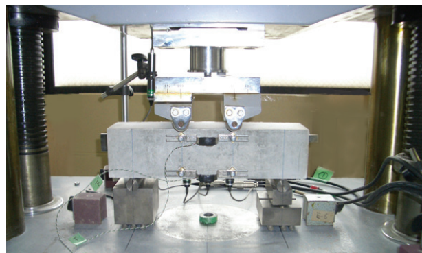
写真-1 曲げ試験状況
