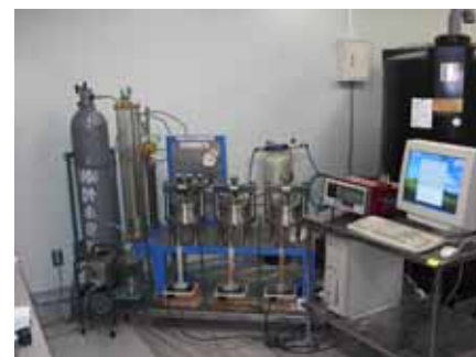
図-1 透水試験装置の外観
