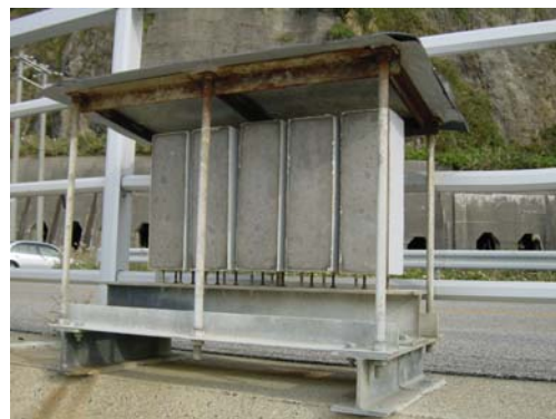
図－3 供試体設置状況
