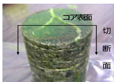
写真-7 B構造物の採取コア状況(蛍光樹脂含浸後)
