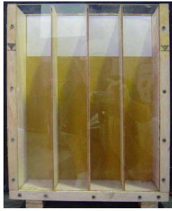
写真-1 透明型枠
