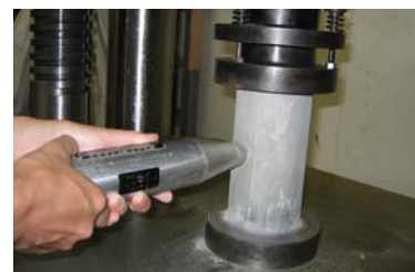
写真-1 円柱供試体の反発度測定状況
