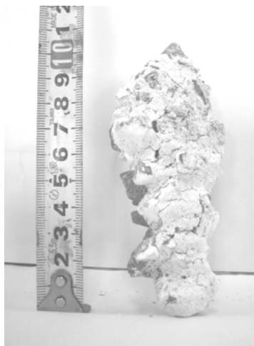
写真-2 硫酸浸漬後の状況変化 (PL : 浸漬 365 日)
