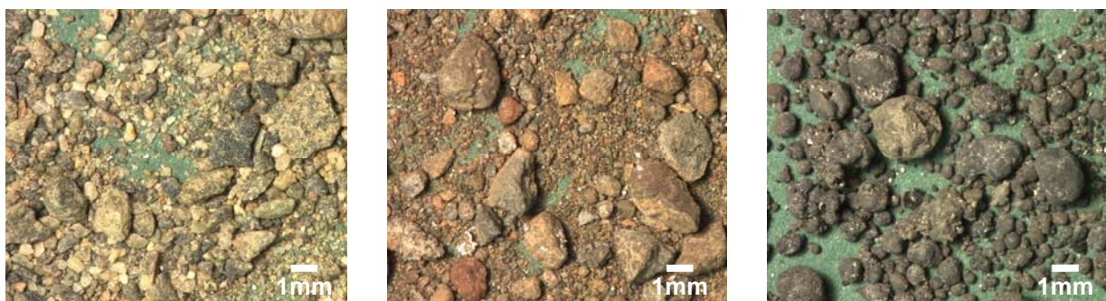
写真-2 使用細骨材の外観比較(左:普通細骨材,中:市販人工軽量細骨材,右:CGS 軽量細骨材)
