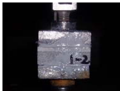
写真-2 付着強さ試験
