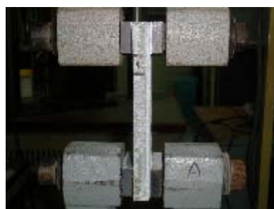
写真-1 ひび割れ抵抗性試験
