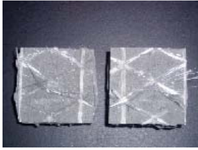
写真-7 付着強さ試験後の試験体 (負荷後)
