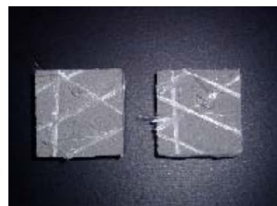
写真-6 付着強さ試験後の試験体 (負荷前)
