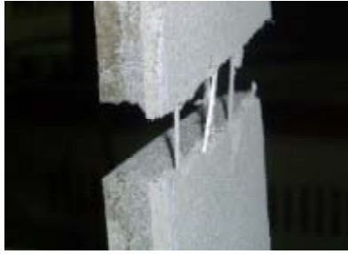
写真-4 ひび割れ抵抗性試験後の試験体 (負荷前)
