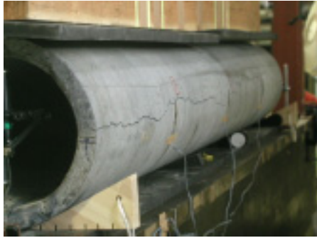
写真 - 5 軸方向ひび割れ (外圧試験)
