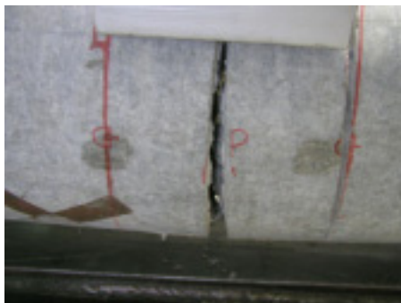
写真 - 6 周方向ひび割れ (曲げ試験)
