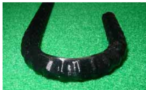
写真-4 被覆厚0.33mm曲げ加工後状況
