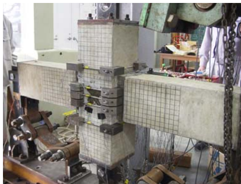
写真-1 PC外部横補強筋取り付け試験体(No.2)
