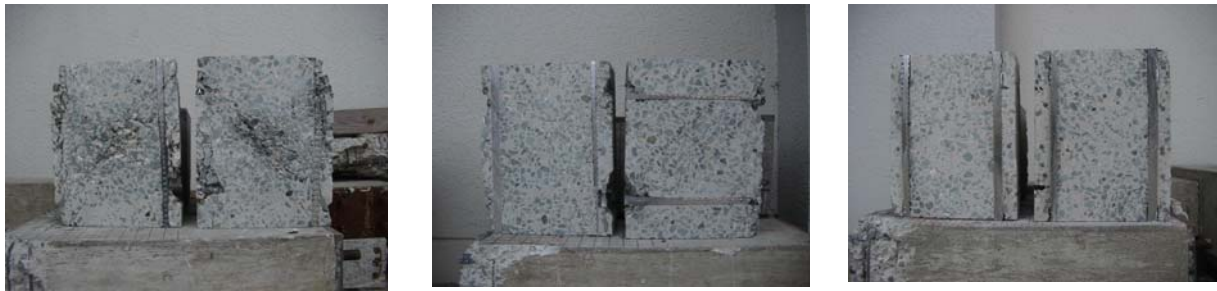
(a) No.1 試験体 (PC 補強なし) (b) No.2 試験体 (PC 外部横補強) (c) No.3 試験体 (PC X 形補強)
