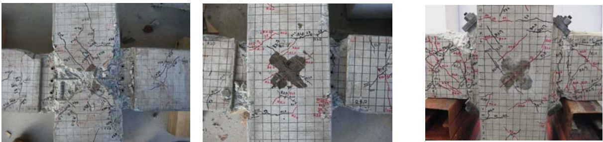
写真-3 試験体の全体の破壊状況 (東面)
