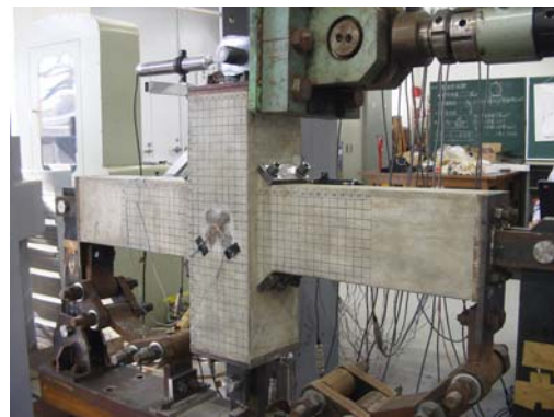
写真-2 PCX形補強筋取り付け試験体(No.3)
