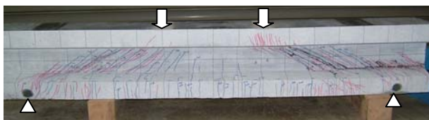
写真-2 試験体の破壊状況（試験体 SPC1）
