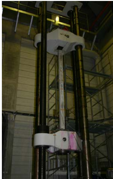
写真-2 万能試験機による引張試験
