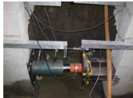
図-7 载荷部 詳細図
