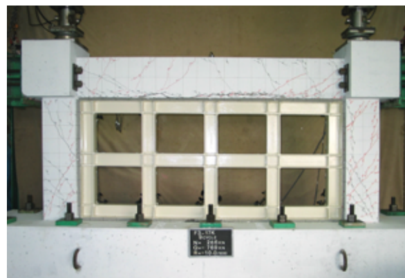
(b) 試験体 F3-17K (格子型鉄骨フレーム) 写真-1 ひび割れ状況 ( R=10/1000 rad.)
