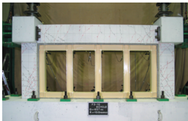
(a) 試験体 F3-10 (せん断すべり破壊先行)
