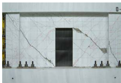
写真-2 O3の破壊状況
