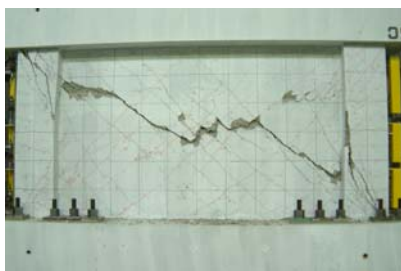
写真-1 ONの破壊状況
