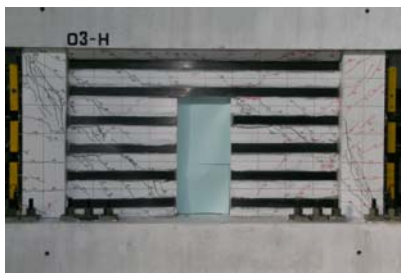
写真-3 03-Hの破壊状況
