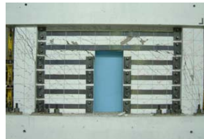
写真-5 03-Haの破壊状況
