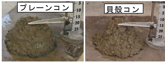
写真-3 スランプ試験の状況
