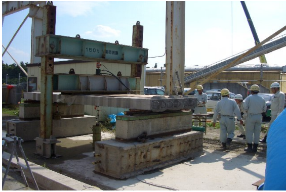
写真－１ 曲げ載荷試験
