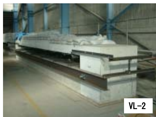
写真-1 試験体載荷状況
