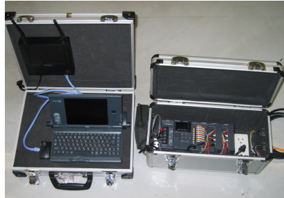
a)データ送信状況 b)送受信機(左:受信機 右:送信機) c)データ受信状況 写真 - 4 無線 LAN 伝送実験
