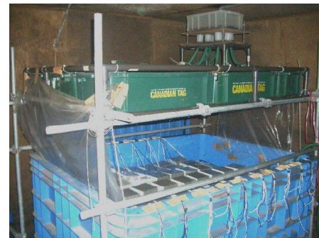
写真-3 酸性雨劣化促進試験装置
