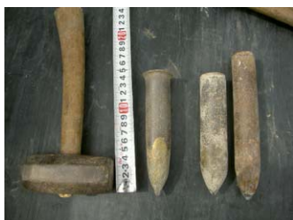
写真-3 「はつり仕上げ」に使用した道具
