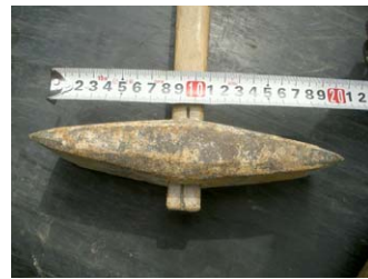
写真-1 「小叩き仕上げ」に使用した道具
