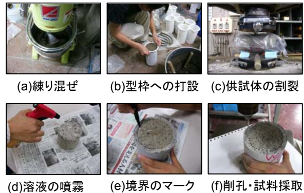
写真-2 作業の様子
