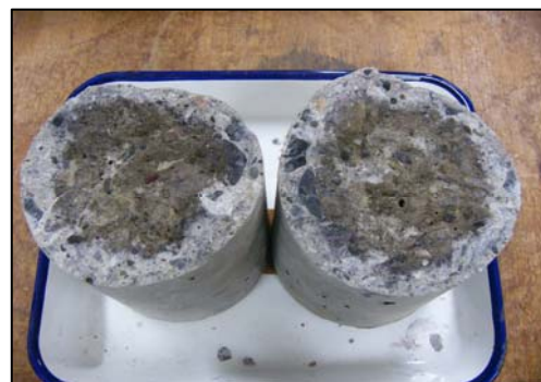
写真-1 硝酸銀溶液を噴霧したコンクリート割裂面
