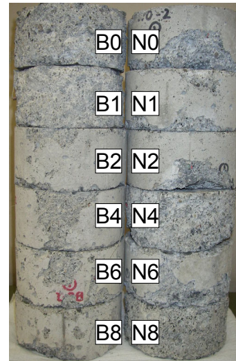
写真-1 467 サイクル後の供試体 (劣化が最も著しかった部分を撮影)
