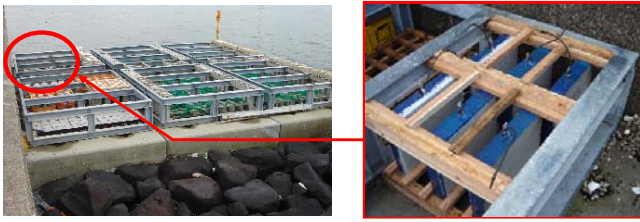
写真-5 海洋環境への暴露状況
