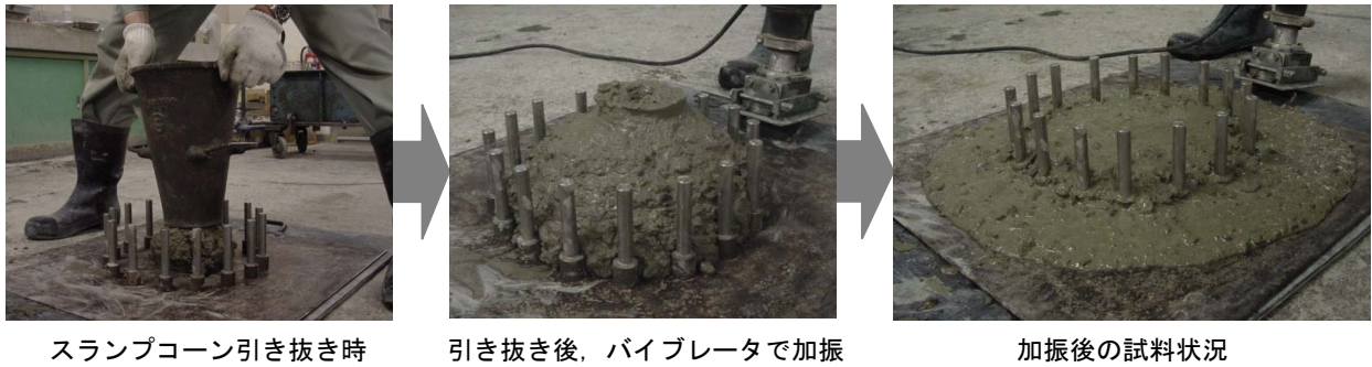
写真-1 簡易施工性評価試験による試験状況
