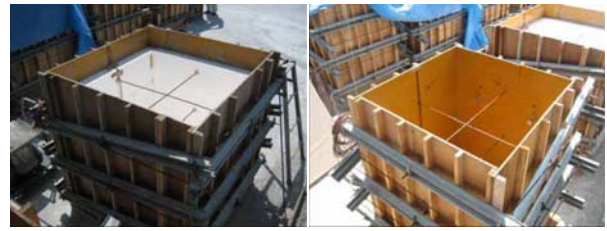
6面断熱養生 2面断熱養生
