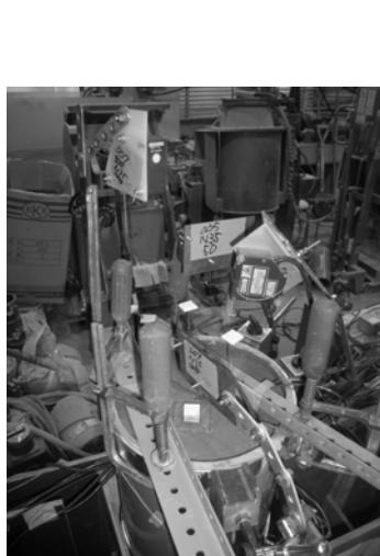
写真-1 沈降試験装置
