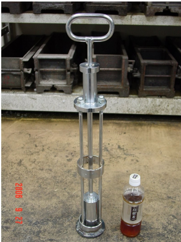
写真-1 下部に鉄板を溶接したランマー
