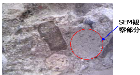
写真-3 SEM 観察用の試験体
