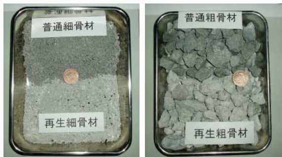
写真-1 低度処理再生細・粗骨材
