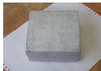
図-3 使用したコンクリート供試体
