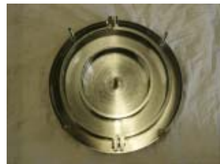
写真-1 リング型拘束応力試験型枠
