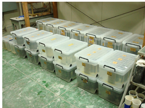
図-2 硫酸浸漬試験
