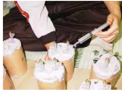
写真 5 水の先行注入
