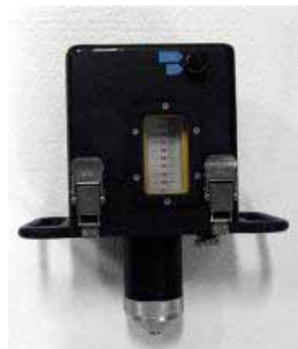
写真 - 1 水中リバウンドハンマー試験機
