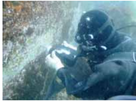
写真 - 6 水中リバウンドハンマー試験の試験風景
