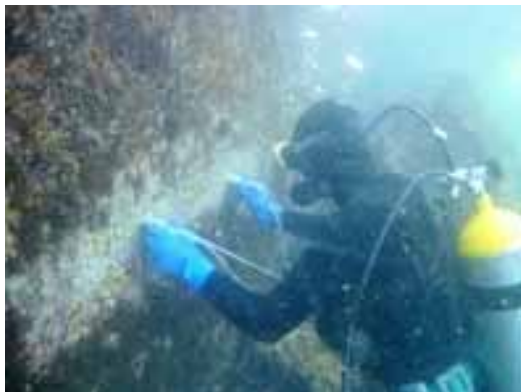
写真 - 5 水中超音波試験の試験風景
