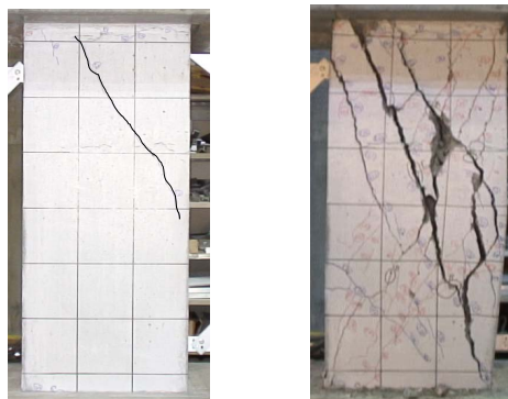
a) 最大耐力時 (0.25%) b) 崩壊付近 (3.0%) 写真-1 試験体 S2 の破壊状況
